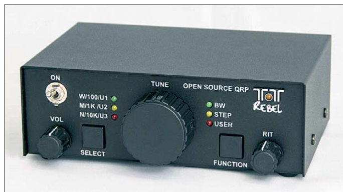
QRP-Transceiver Ten-Tec 506 Rebel, speziell für experimentierfreudige Amateure
