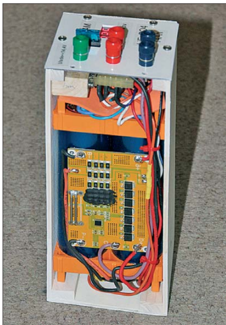
Bild 1: Blick in das geöffnete Gehäuse des Akkupacks mit der BMS-Platine vorn
