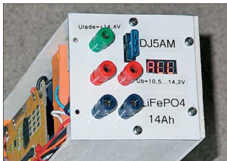
Bild 3: Frontplatte des Akkupacks mit Anschlussbuchsen, Sicherung und Anzeige
