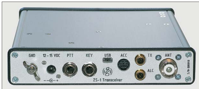
Bild 8: Die Rückseite des ZS-1 verfügt über reichlich Schnittstellen.
