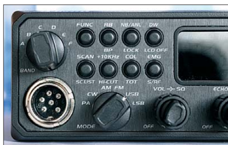
Der Schalter Band dient zum Wechseln zwischen den Speichergruppen; Sendarten werden manuell gewählt und lassen sich nicht zu einem Kanal speichern.
