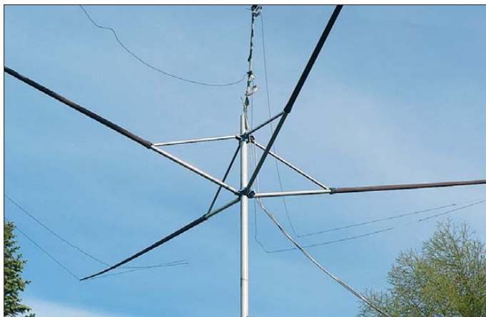
Bild 1: Zwei 3-Element-Antennen für 14 MHz und 21 MHz mit einer Wäschespinnne als zentraler Stütze
