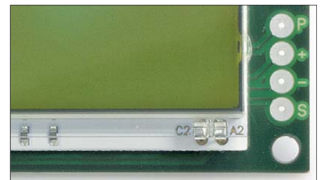
Bild 5: Die Kontaktflächen zum Programmieren sind auch auf der Vorderseite der Platine zugänglich und hier entsprechend ihrer Funktion beschriftet.
