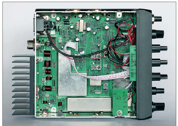
Das Funkgerät hat etwa Autoradioformat; am linken Bildrand sind die auf der Rückseite montierten Kühlrippen zu sehen.
