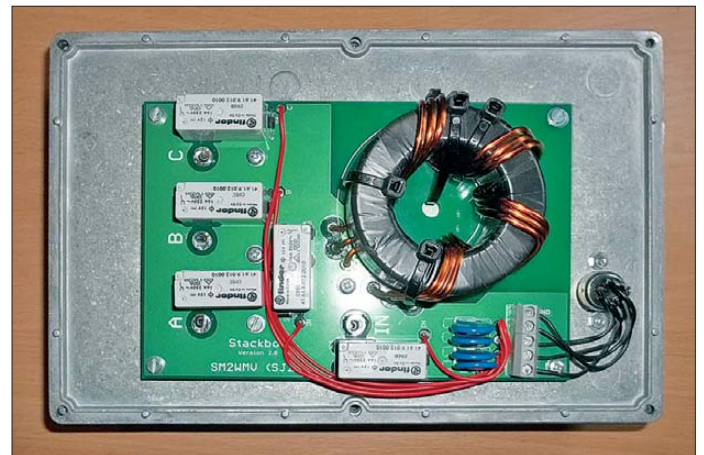
Bild 1: Antennenschalter (Stackmatch) im Aluminium-Druckgussgehäuse; über die fünfpolige DIN-Buchse werden die Steuerspannungen zugeführt.
