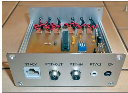
Bild 10: Zum Anschluss von Funkgerät und Stackmatch dienen Standardbuchsen. Das erleichtert die Herstellung der Verbindungskabel, es können bereits konfektionierte Ausführungen verwendet werden.
