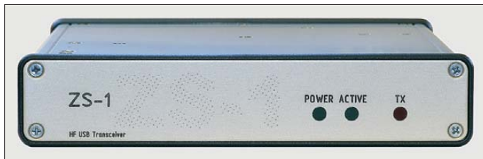
Bild 1: An der Frontseite des ZS-1 sind lediglich Anzeigeelemente zu erkennen; die Bedienung erfolgt durchweg über den PC.
