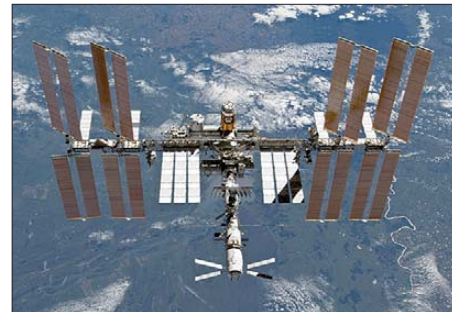
Die Fläche der ISS beträgt nur etwa 30 m 2 , wobei die Sonnensegel bei ISS-Scatter-QSOs wohl den größten Beitrag zur Signalreflexion liefern dürften. Foto: NASA
