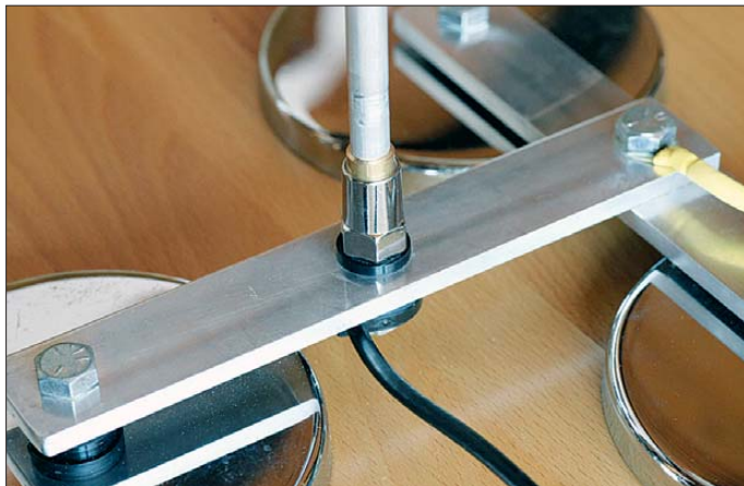
Dank 3/8-Zoll-Gewinde lässt sich der Mobilstrahler von Winkler mit einem großen Magnetfuß verwenden.
